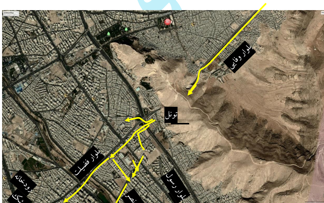
شکل ۳-۱۱ مسیر حرکت سیلاب از تونل سعدی به حوضه شیراز (کارگروه مهندسی رودخانه و سازه‌های هیدرولیکی، ۱۳۹۸)
