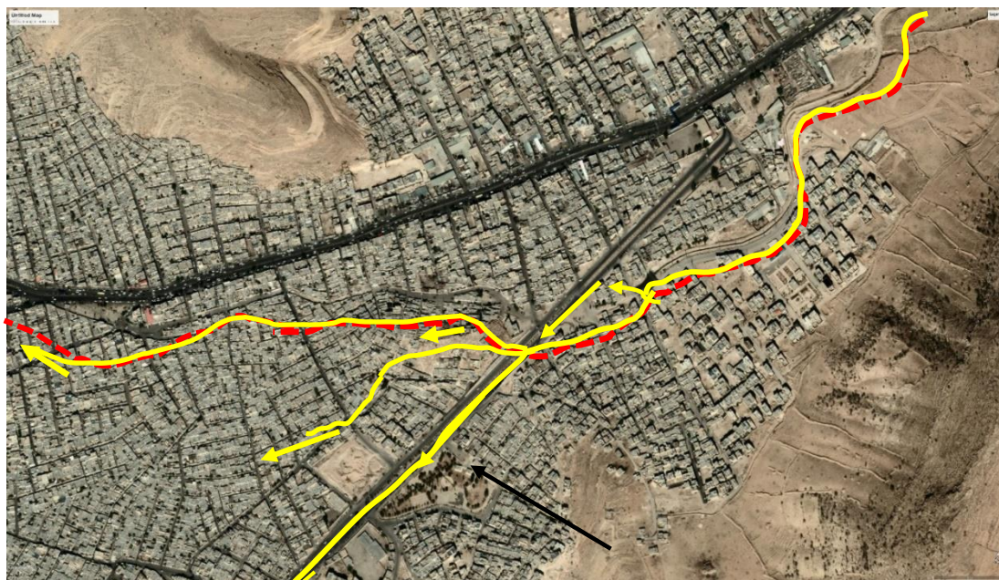
شکل ۳-۱۰ مسیر اصلی مسیل سعدی (خطوط قرمز) و مسیر حرکت سیل اخیر (خطوط زرد) (کارگروه مهندسی رودخانه و سازه‌های هیدرولیکی، ۱۳۹۸)
